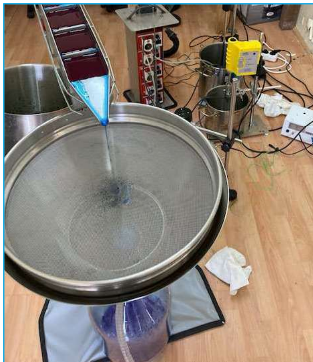
ABBILDUNG 20: GESAMTE IM KONTINUIERLICHEN ANSATZ LAUFENDE EXTRAKTIONSANLAGE
